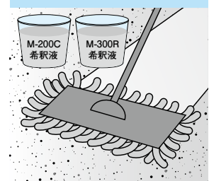
【図2】洗浄剤・剥離剤の塗布・洗浄
